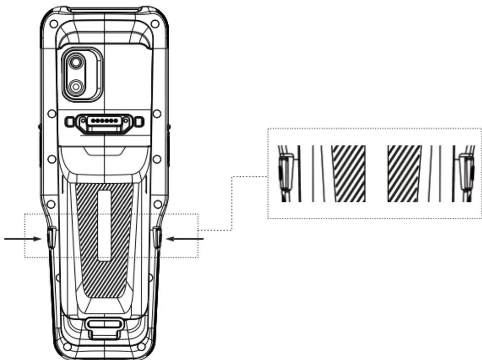
2.按压两侧的开关,电池朝下,电池自然掉落下来。
