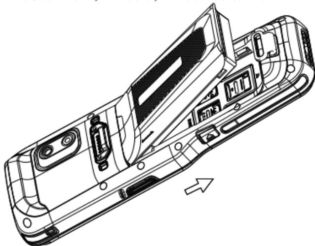
\* 收到设备后请先撕开电池正负极绝缘贴,然后再开启设备。
