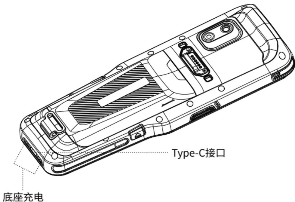
\* 为防止电池出现过耗状态，请您在设备电量低于20%时为设备电池充电。若电池已经出现过耗保护状态时，请静置设备充电20-30分钟后，设备将会重新显示正常充电。
